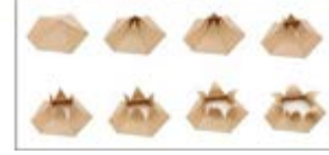
HygroSkin-Meteorosensitive Pavyonu Modüllerinin Açık ve Kapalı Pozisyonu
